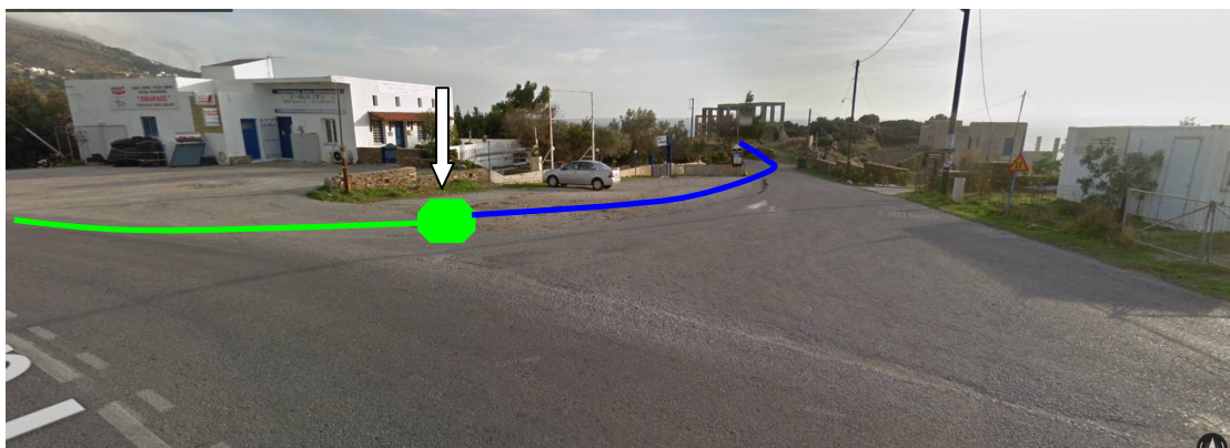
Φ6. Άποψη της διαδρομής του καταθλιπτικού αγωγού μεταφοράς επεξεργασμένων λυμάτων ΚΔΜ (πράσινο) έως το φρεάτιο απόδοσης ΦΑ.Μ και στην συνέχεια ο βαρυτικός αγωγός ΔΜ (μπλε) (Α' είσοδος Μπαταίου).
