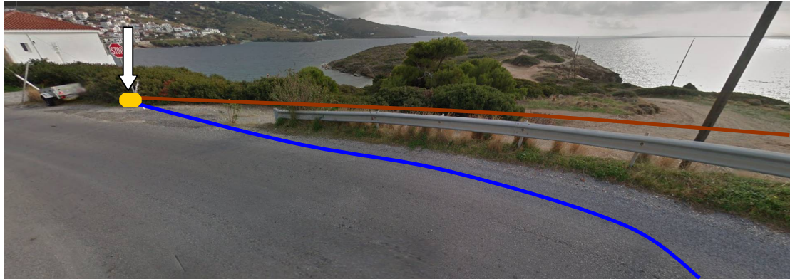
Φ1. Άποψη της διαδρομής του αγωγού μεταφοράς επεξεργασμένων λυμάτων (μπλε) που καταλήγει στο φρεάτιο φόρτωσης και από εκεί ξεκινά ο αγωγός διάθεσης (καφέ). Στο βάθος φαίνεται το ακρωτήριο Κολώνα.
